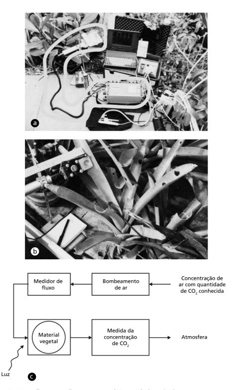
**Figura 28.6:** Aparelho para medir trocas gasosas ( $CO_2$  e  $H_2O$ ), denominado IRGA (analisador de gases por infravermelho), em destaque (a); detalhe da câmara foliar, onde se coloca a folha para que fique isolada do ambiente e possamos medir as trocas gasosas (b); esquema dos principais componentes do IRGA (c). Com os valores de concentração de  $CO_2$  e  $H_2O$  no ar atmosférico e no interior da câmara, podemos calcular as taxas de fotossíntese e transpiração (veja equações).
