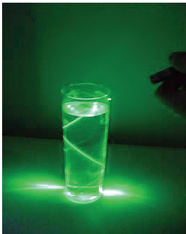
Figura 9: Utilizando um copo com água e leite, conseguimos reproduzir o fenômeno da reflexão total, responsável pelo funcionamento das fibras ópticas.
