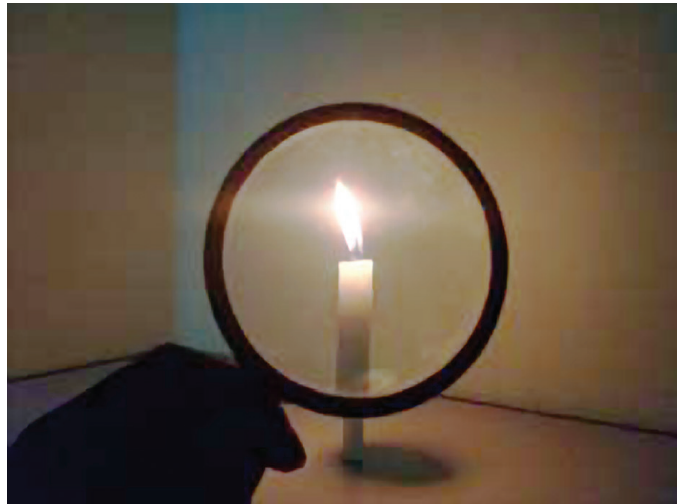
Figura 18: Quando o objeto está entre o vértice e o foco, a imagem é maior, virtual (formada pela projeção de raios) e direita.
