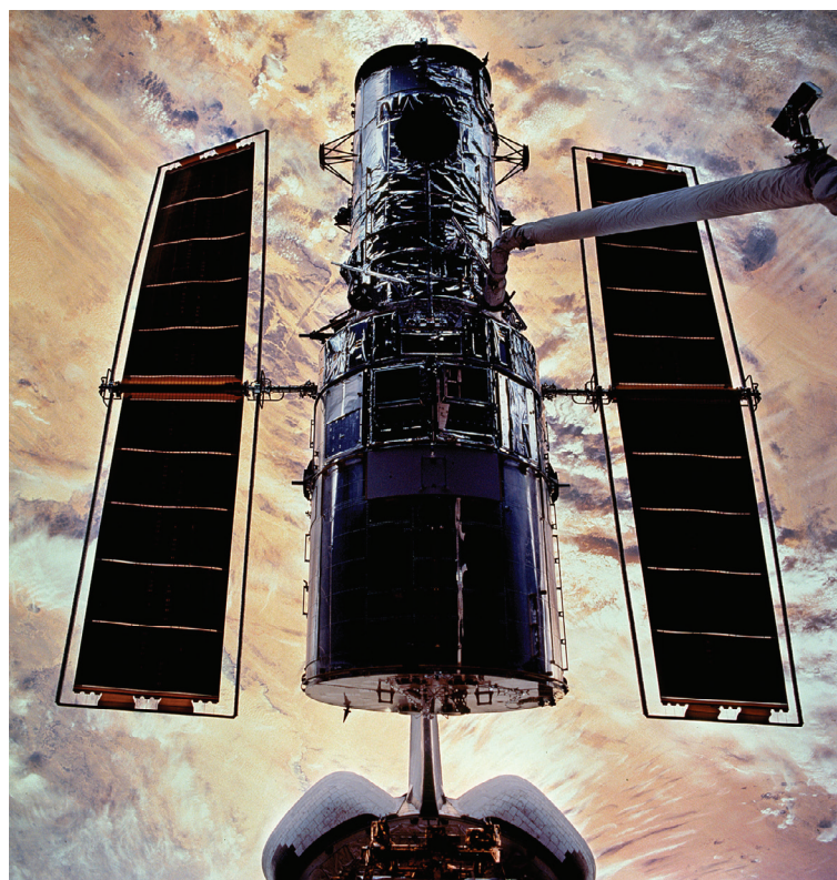
Figura 1: Hubble é um satélite astronômico artificial que não possui tripulação e transporta um grande telescópio que captura tanto a luz visível quanto a infravermelha.
