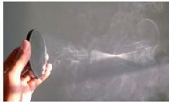
Figura 19: Em (a), temos destacados dois tipos de raios especiais. Um deles é o que viaja paralelamente ao eixo focal (e que é refletido de modo a passar pelo foco do espelho), e o que incide no vértice. Em (b), temos um feixe de raios solares paralelos ao eixo focal incidindo num espelho côncavo. Com o auxílio de fumaça, vemos a convergência desses raios no foco do espelho.
