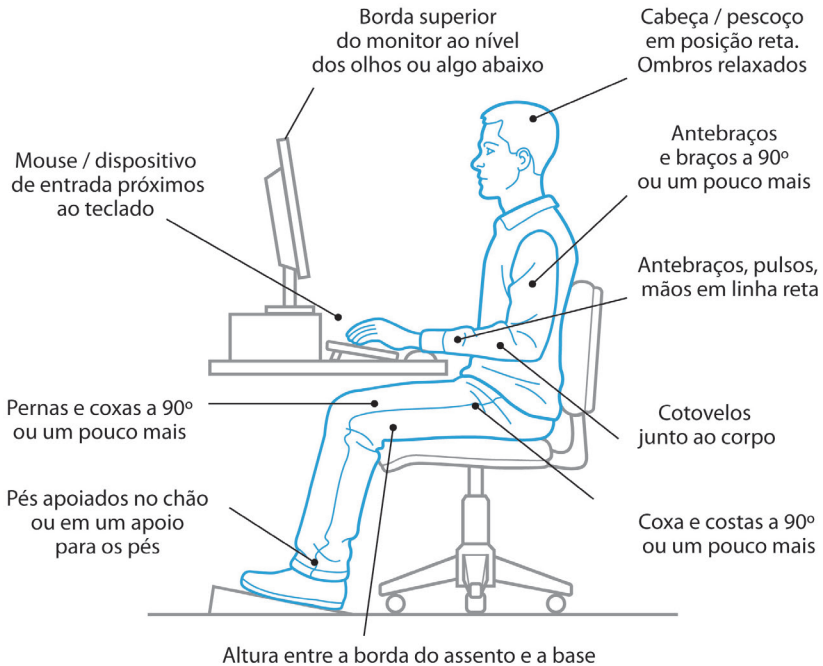
Figura 7.8: Dimensões ideais de uma estação de trabalho para quem trabalha sentado.
