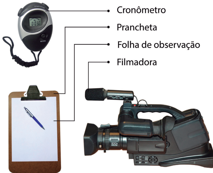
Figura 8.1: cronômetro, filmadora e prancheta são alguns dos equipamentos necessários para o estudo de tempo.
