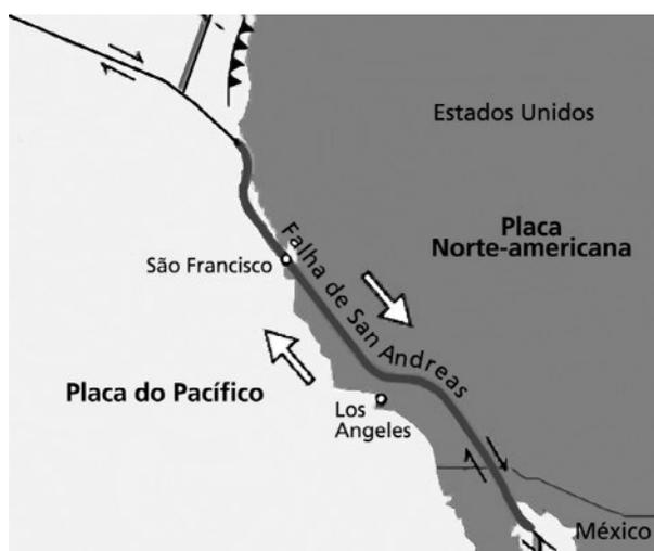
**Figura 6.8:** Limite de placa conservativo ou transformante, onde não há destruição de placas.
