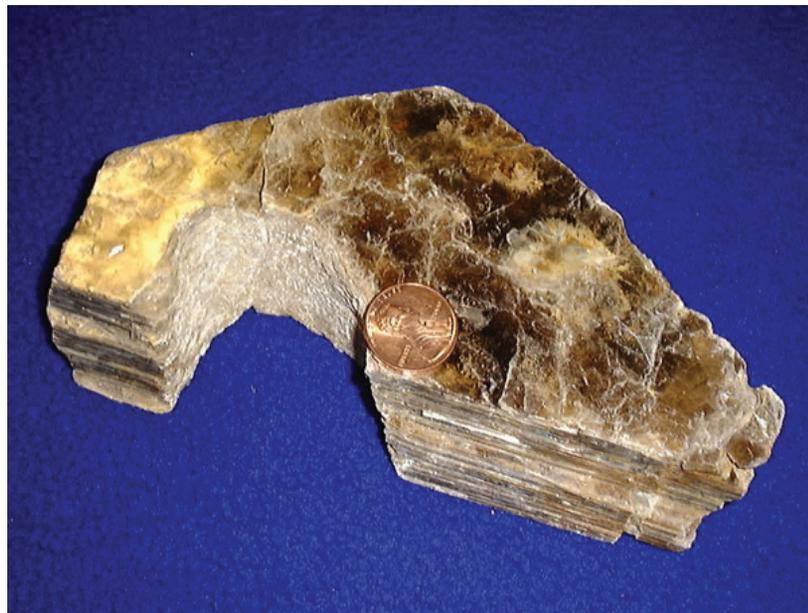
**Figura 2.1:** O mineral mica possui divisão perfeita. As placas ou lamelas deste mineral são explicadas pela disposição dos átomos ao longo de planos sucessivamente paralelos.
