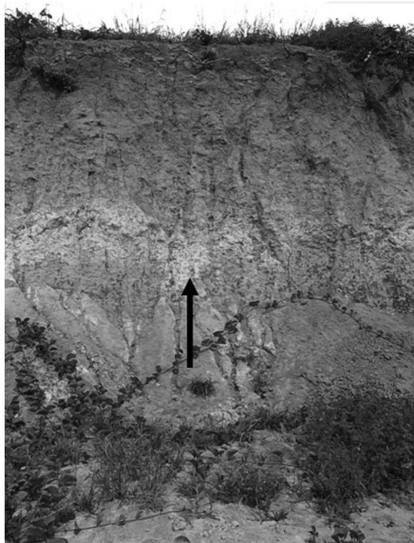
**Figura 4.7:** Perfil de solo residual. A seta assinala a zona de transição entre a rocha alterada e o solo propriamente dito.
