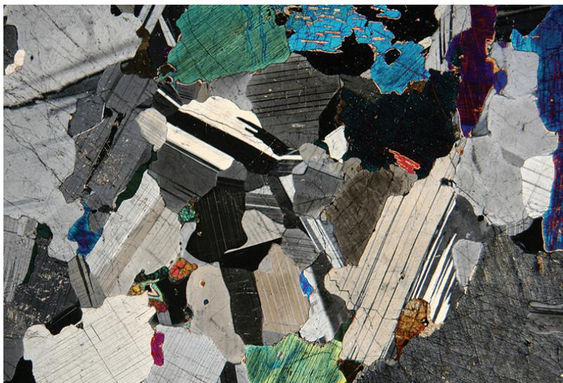
**Figura 2.4:** Lâmina delgada de gabro, mostrando o arranjo dos minerais.
