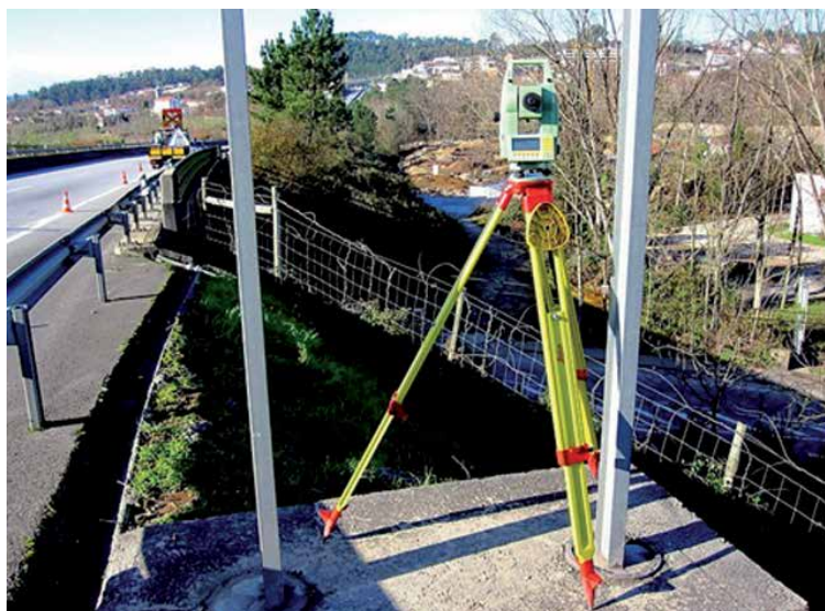
Figura 3: Teodolito utilizado pelo agrimensor.
