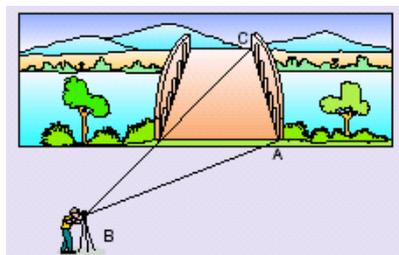
2- Uma ponte deve ser construída sobre um rio, unindo os pontos A e B, como ilustrado na figura abaixo. Para calcular o comprimento AB, escolhe-se um ponto C, na mesma margem em que B está, e medem-se os ângulos  $\hat{CBA} = 57^\circ$  e  $\hat{ACB} = 59^\circ$ . Sabendo que BC mede 30m, indique, em metros, a distância AB. (Dado: use as aproximações  $\text{sen}(59^\circ) \cong 0,87$  e  $\text{sen}(64^\circ) \cong$
