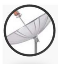
As antenas parabólicas em geral têm um grande diâmetro para captar uma quantidade maior de sinais do satélite, portanto a distância focal é em geral grande por causa disso. Veja na foto à cima onde está o foco: é nele que fica o captador dos sinais de TV.
