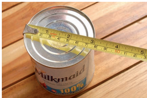
Figura 2: Medindo o diâmetro usando a fita métrica.
