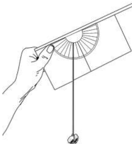
Imagem 3 teodolito em construção
