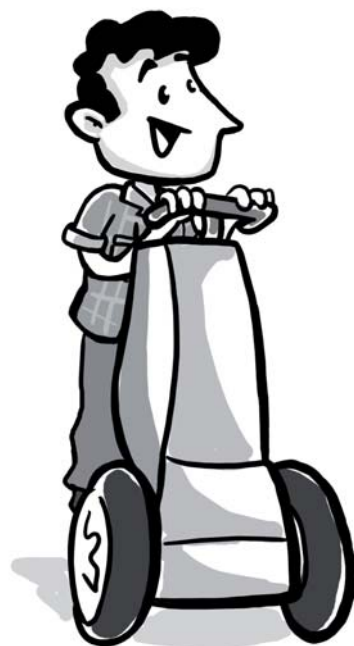
Figura 8.3: Segway é um veículo de duas rodas e um guidão que se movimenta a partir do equilíbrio e do grau de inclinação do corpo do condutor. O aparelho será usado para atendimento aos segurados do Bradesco no Rio de Janeiro e de São Paulo.
