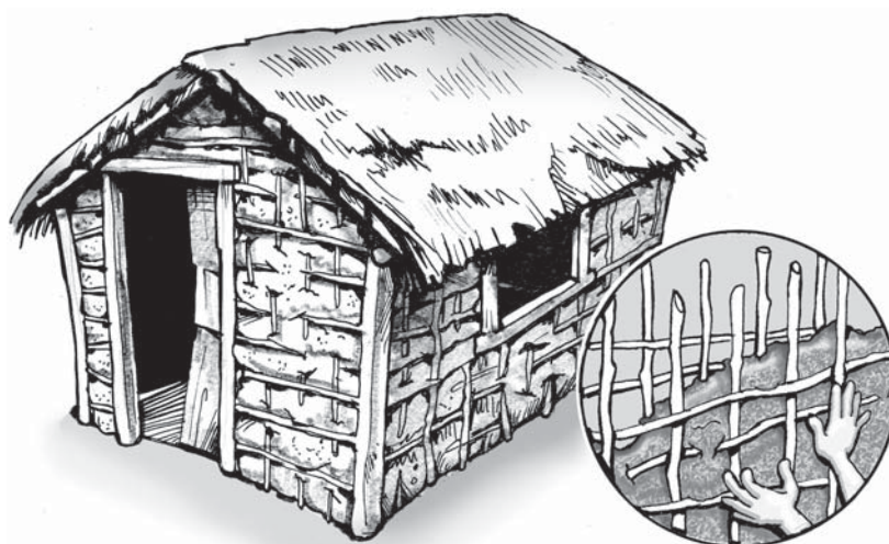
Figura 12.2: Arquitetura - Casa de sopapo: sopapo ou pau-a-pique é uma técnica de construção segundo a qual a parede é armada com madeira ou bambu e preenchida com barro e fibra.
