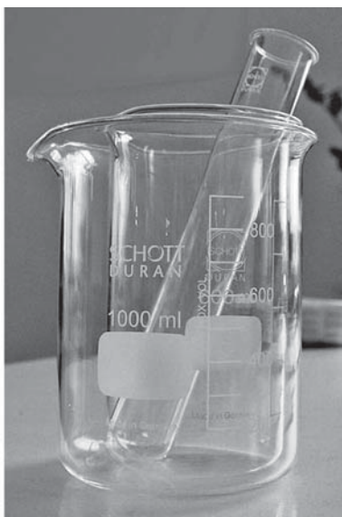
Figura 3.1: Vidro à prova de choque térmico usado em laboratório, podendo ser colocado diretamente sobre o fogo sem risco de se quebrar.
