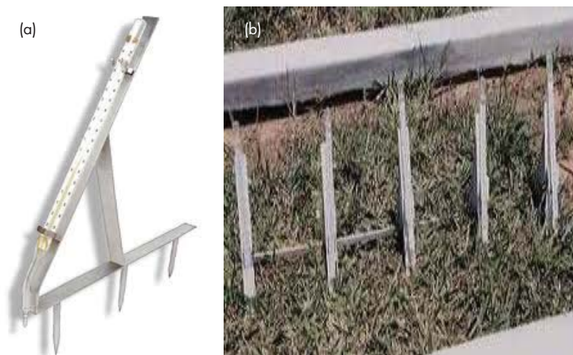
Figura 14.11: Termômetro de solo (a) e termômetros de solo instalados (b).
