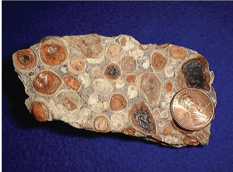
**Figura 11.3:** Minério de bauxita. A moeda está sendo utilizada como escala.
