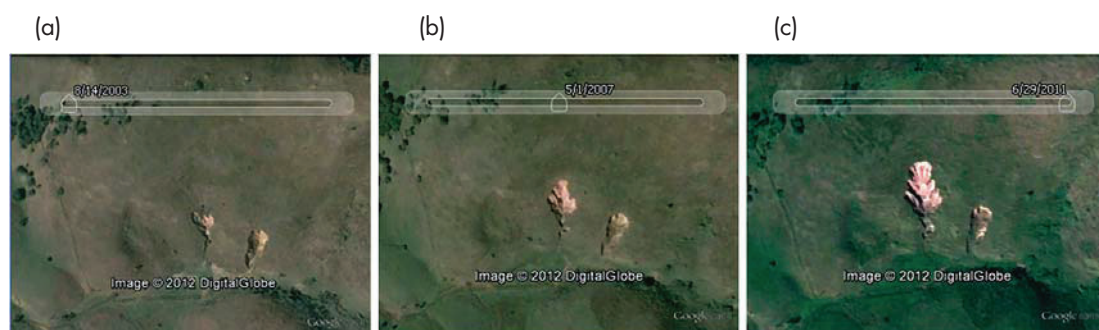
Figura 6.3: Evolução de um processo de voçoracamento registrado por imagens de alta resolução em três etapas, da esquerda para a direita: (a) Início do processo em 2003. (b) Evolução da frente erosiva em 2007. (c) Aprofundamento e alargamento da feição erosiva em 2011.
