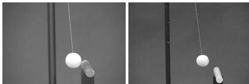
Figura 1.14: (a) Bolinha de isopor neutra sendo atraída pelo bastão de PVC negativo. (b) Bolinha de isopor neutra sendo atraída pelo bastão de acrílico positivo.
