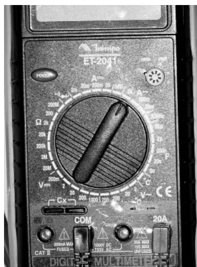
Figura 13.14: Escala para medir correntes alternadas.
