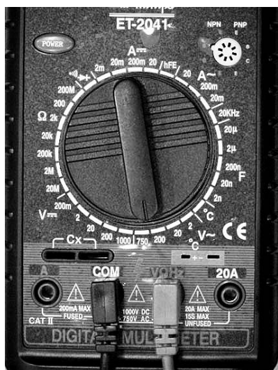
Figura 13.13: Escala para medir voltagens alternadas.
