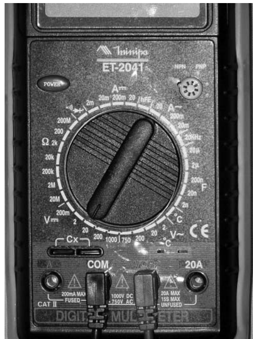
Figura 8.4: Escala de 20V para corrente contínua.
