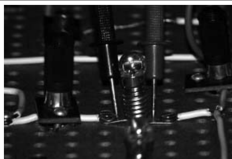
Figura 10.4: Posição das pontas do multímetro na lâmpada na medida da voltagem nos seus terminais.
