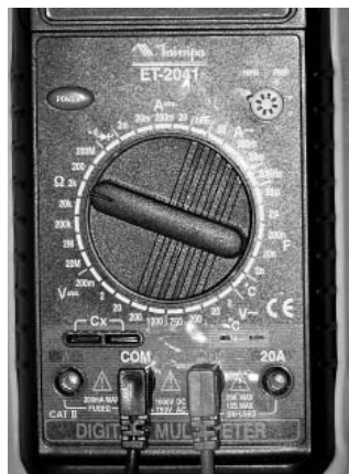
Figura 13.5b: Escala para medir resistências.
