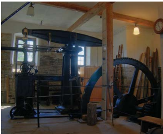
Figura 12.3: Máquina típica da primeira fase da Revolução Industrial que se baseava no princípio de que o calor (sob pressão) é uma forma de energia (ou seja: pode ser utilizado para produzir trabalho). O movimento do vapor impulsionava a grande roda que, por sua vez, transferia trabalho mecânico para o restante da máquina.
