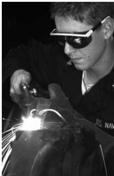
Figura 2.5: Uso da energia liberada pela queima de acetileno para fundir e cortar peças de um navio de guerra norte-americano.
