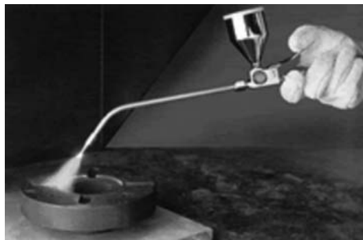
Figura 2.4: Queima do acetileno + oxigênio (oxiacetileno). Fonte: http://www.comersul.com.br/fotos/colmonoy_02.gif
