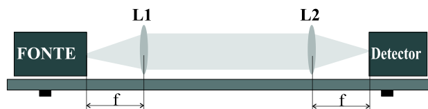
Figura 7.1: Representação esquemática da montagem experimental: posicionamento das lentes.
