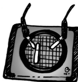
Figura 10.13: Cuba cilíndrica montada em cima da base com eletrodos.
