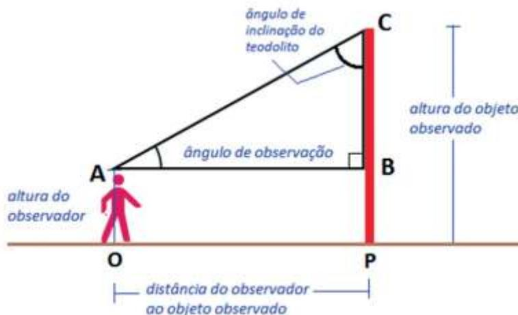
Figura: esquema indicativo das medidas encontradas
