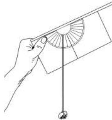
Figura: teodolito em construção
