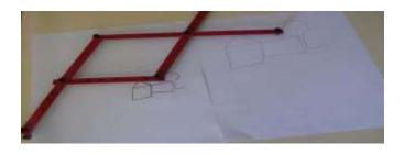
O pantógrafo é um instrumento que permite obter figuras semelhantes utilizando uma homotetia.
