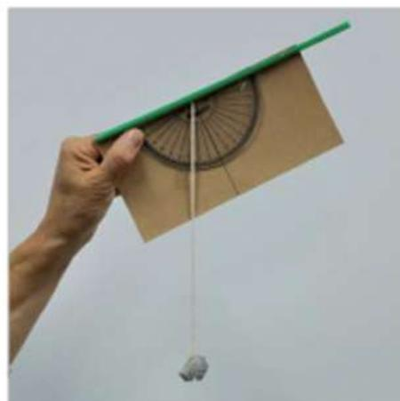
Figura: Teodolito em construção
