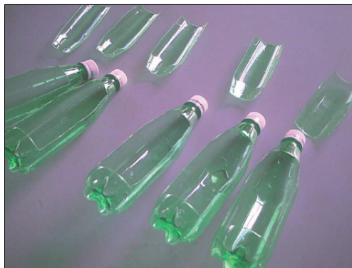
Figura 4. Forma como devem ser cortadas as garrafas pet .
