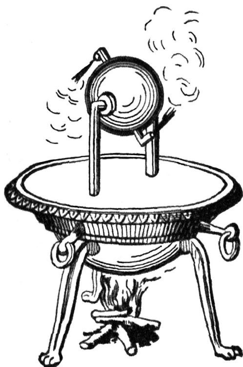
Figura 7.12: A eolípila, inventada no século I por Heron de Alexandria, é considerada o primeiro motor a vapor documentado.
