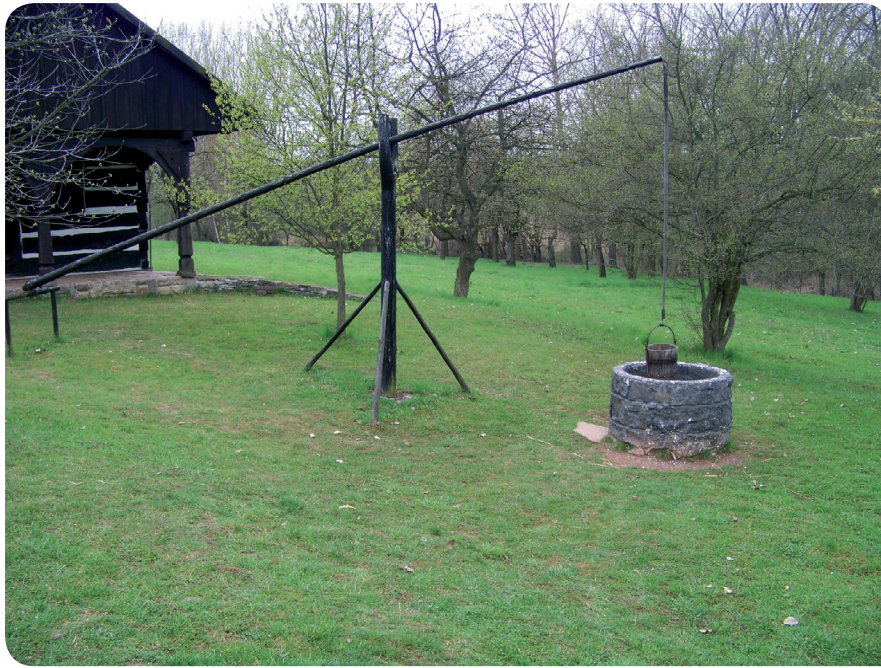
Figura12: Fotografia de 2010 que mostra o uso atual da técnica do shaduf.
