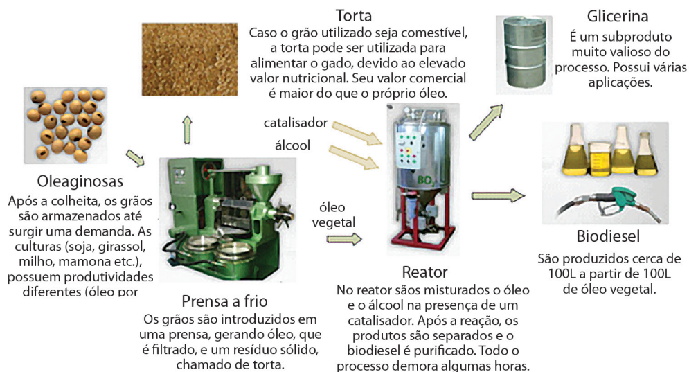
Figura 4: Etapas envolvidas na produção de biodiesel.
