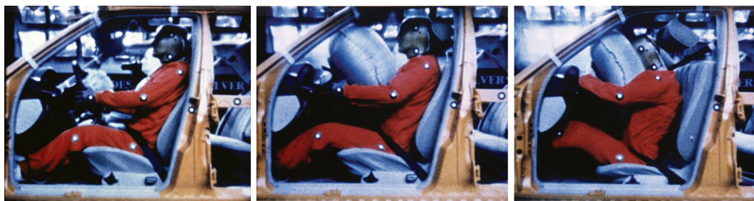
Figura 2: Os airbags são inflados em apenas 4 centésimos de segundo, após a colisão do automóvel, protegendo assim o motorista e o passageiro de lesões mais graves.
