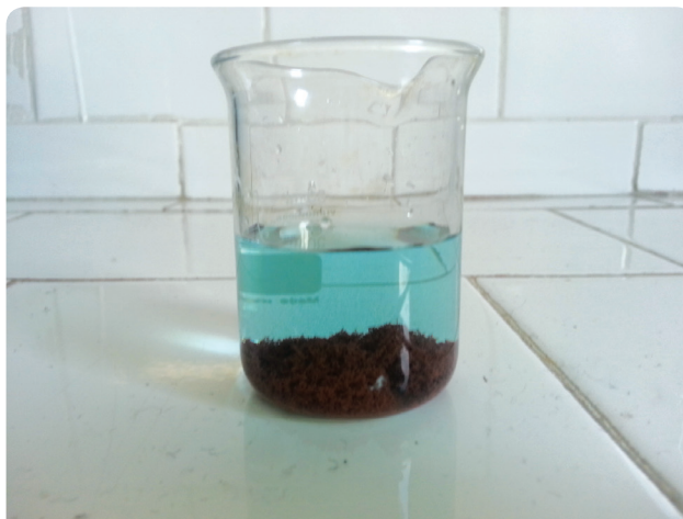
Figura 6: Resultado final da atividade 1. Durante a transformação química, ocorre a formação de um depósito castanho-avermelhado sobre a superfície da palha de aço, e a solução perde a sua coloração azulada. Com o passar do tempo, a palha de aço se dissolverá, restando apenas o depósito formado.
