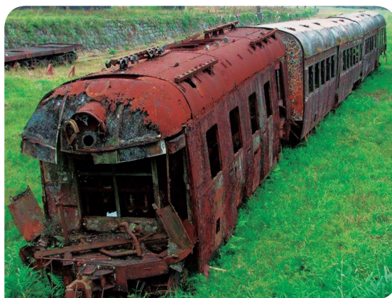
Figura 12: A ferrugem é resultado da oxidação do ferro que tem como um dos seus produtos o óxido de ferro, é ele o responsável pela cor avermelhada.
