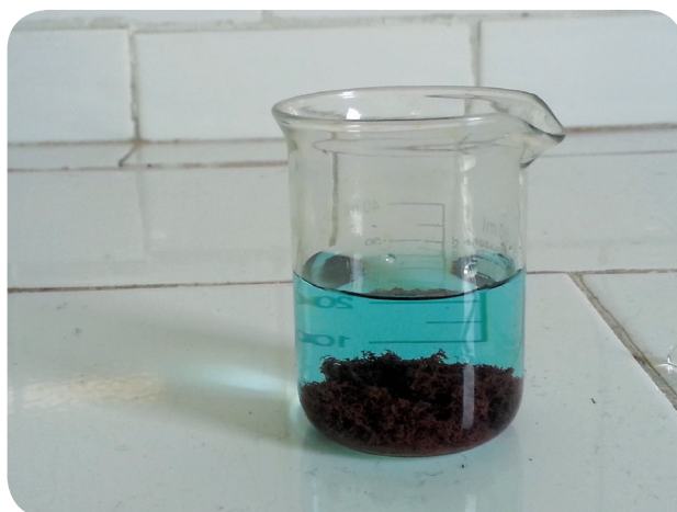
Figura 4: A solução de sulfato de cobre ( \text{CuSO}_4 ) possui coloração azul característica devido à presença de íons \text{Cu}^{2+} (foto da esquerda). Ao final do experimento a cor da solução foi alterada (foto da direita).
