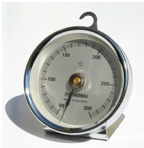
Figura 4: Termômetro de lâmina bimetálica.
