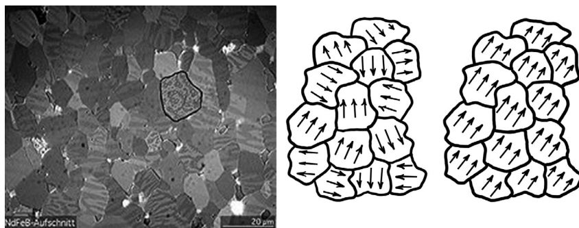
Figura 10: À esquerda, temos uma fotografia ampliada (utilizando-se um microscópio Kerr) que mostra os domínios magnéticos de NdFeB. À direita, temos a representação esquemática dos domínios magnéticos. Se aplicarmos um campo magnético suficientemente intenso, podemos alinhar todos estes domínios na direção deste campo aplicado.
