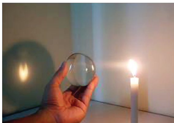
Figura 16: Imagem da vela, projetada na parede com o auxílio de uma lente convergente.
