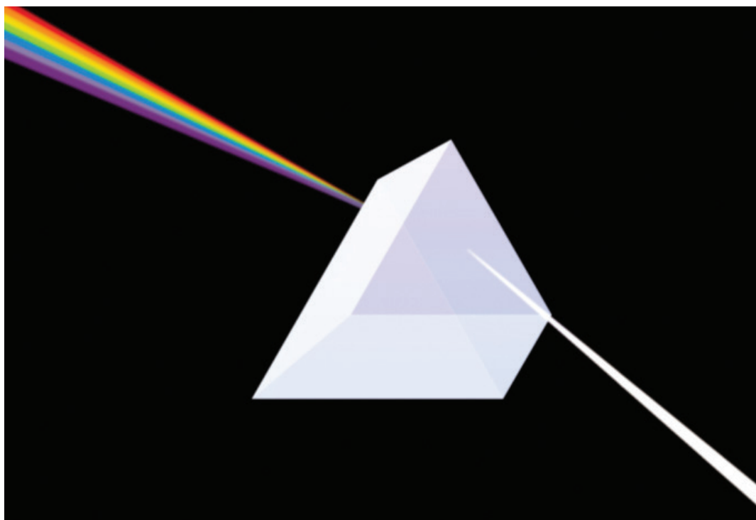
Figura 2: Decomposição da luz branca por um prisma de vidro.
