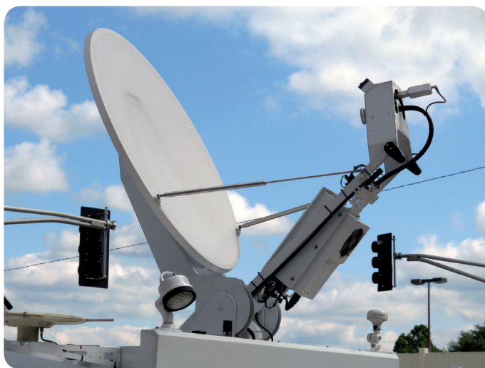
Figura 16: Antena para transmissão via satélite situada no teto de um caminhão de TV.
