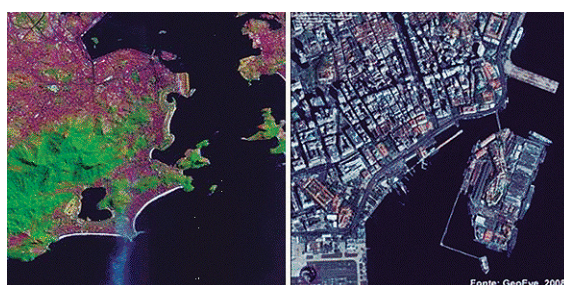
Figuras 3.20: Exemplos de imagens obtidas por sensores com resoluções espaciais diferentes (diferentes IFOVs). Imagens do Landsat-7 (1999) e do GeoEye (2002) da cidade do Rio de Janeiro (uma parte da baía de Guanabara e da zona portuária), com resoluções espaciais de 30 m e 1 m, para escalas de 1:25.000 a 1:10.000, respectivamente.
