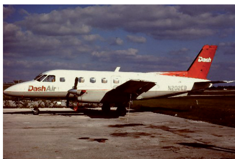
Figura 8.1: EMB-110 Bandeirante (1984). Avião desenvolvido para aviação regional (15 a 21 passageiros) ou para patrulha militar, fabricado e exportado pela EMBRAER (Empresa Brasileira de Aeronáutica S.A., fundada em 1969).
