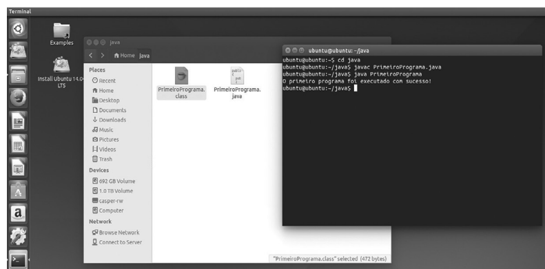
Figura 1.13: Execução do primeiro código-fonte. Para executá-lo, você deve utilizar, no terminal, o comando “java PrimeiroPrograma”. A mensagem “O primeiro programa foi executado com sucesso” será exibida.
