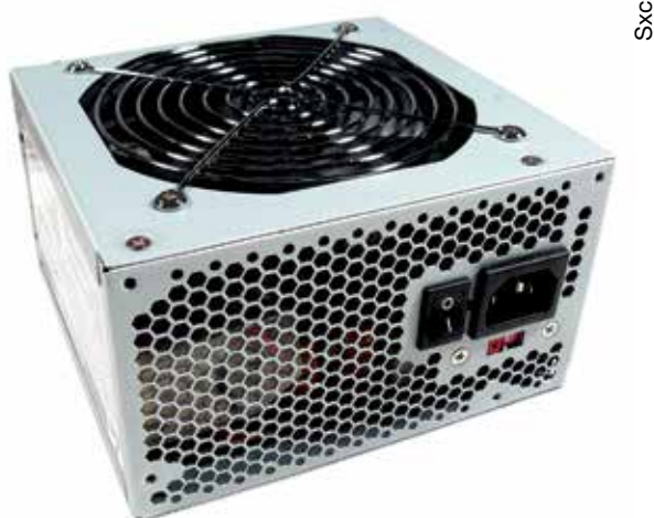
Figura 9.1: Fonte de computador. A falha do componente fonte faz com que não haja corrente para alimentar o computador e, conseqüentemente, ele não funcionará. Dessa forma, a análise da confiabilidade e do modo de falha dos componentes é um processo necessário à compreensão das possíveis falhas em máquinas ou equipamentos.
