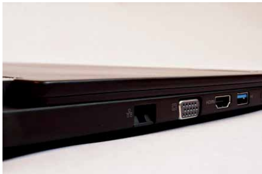
Figura 11.9: Portas de computador. Repare que não é possível plugar o conector do monitor do computador na porta do mouse, ou o teclado na porta de conexão com a Internet. Isso é proposital, para impedir danos por falha humana.
