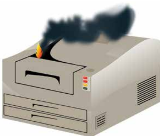
Figura 5.1: Falha em equipamento. As falhas representam o não cumprimento do que é esperado do equipamento. Por exemplo, uma impressora que, por qualquer razão, deixa de imprimir os documentos. As causas podem variar desde algo simples, como um mau-contato de um componente elétrico, a aspectos mais complexos e perigosos, que podem, por exemplo, causar incêndios por curtos-circuitos.
