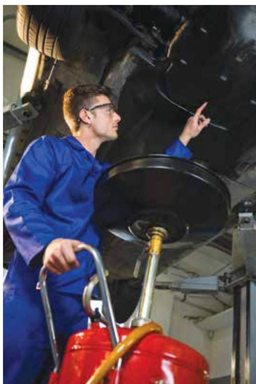
Figura 10.5: Um exemplo típico de manutenção preventiva é a troca de óleo do motor ou caixa de transmissão dos automóveis.
