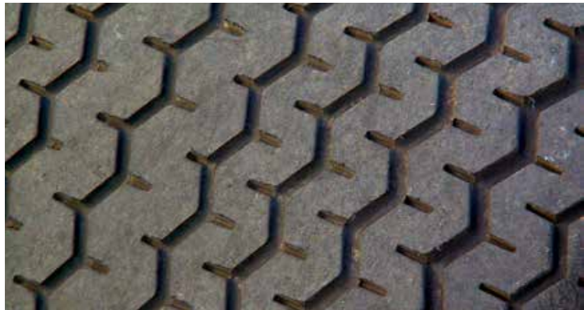
Figura 10.6: Sulcos em pneu. A razão de os pneus terem sulcos em sua banda é a de garantir uma melhor aderência com o piso. Dessa forma, se os sulcos ficam rasos demais (ou mesmo somem), devido ao desgaste da superfície da banda, essa função fica comprometida e, conseqüentemente, os pneus se tornam inapropriados para o uso, devendo ser substituídos.
