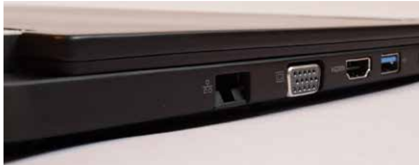
Figura 7.5: Portas de computador. Repare como as diferentes configurações das portas impedem que seja cometido algum erro ao conectar acessórios ao computador: por exemplo, não há como conectar o cabo da Internet no conector a ser usado para ligar um datashow etc.
