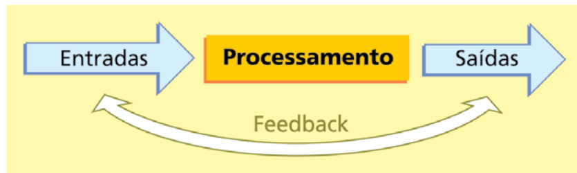
Figura 4.5: Representação esquemática de um sistema. Observe que um sistema é composto por entradas, processamento e saídas, e que é através das entradas e saídas que ele se relaciona com o meio externo, interagindo com outros sistemas.
