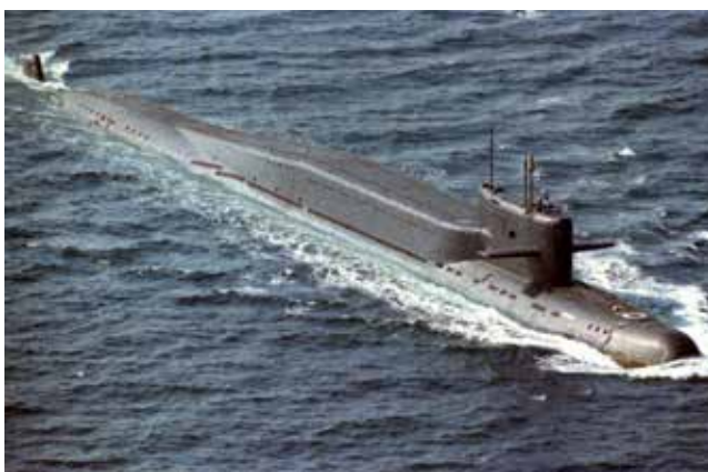
Figura 4.8: Delta-II class nuclear-powered ballistic missile submarine 2. Usamos princípios de fluídoestática para calcular forças sobre cascos de, por exemplo, submarinos.
