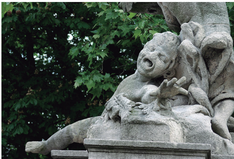
Figura 12.14: efeito da precipitação ácida numa estátua em calcário.
