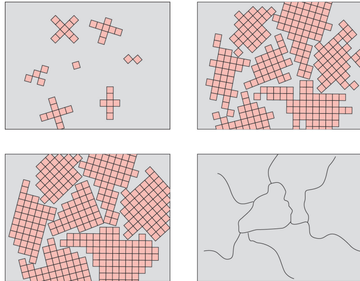
Figura 2.24: Evolução da solidificação para formação dos grãos.
