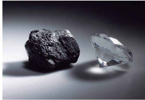
Figura 5.2: Alótropos do carbono, o diamante e o grafite se apresentam com características visuais tão diferentes quanto as suas características cristalinhas!
