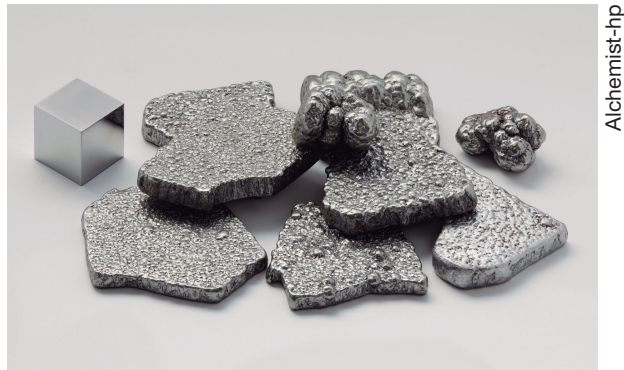
Figura 2.6: Ferro eletroliticamente refinado, com elevado grau de pureza.
