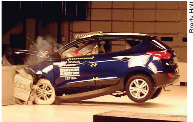
Figura 3.2: Teste mede a ductilidade do aço utilizado na fabricação da carroceria da máquina Tucson, da Hyundai.
