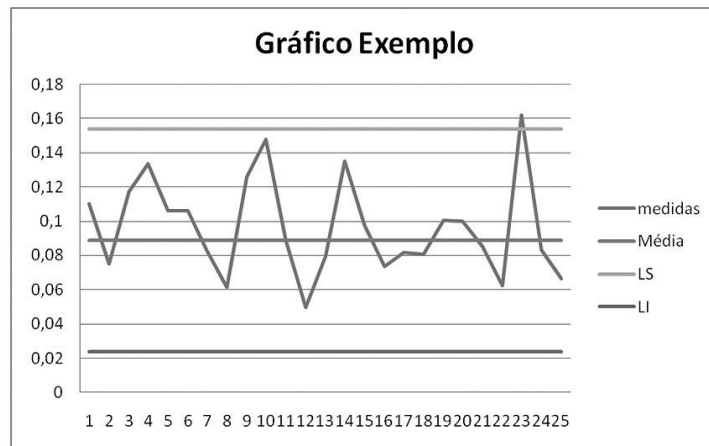
Figura 6.7: Exemplo de gráfico de controle. Os gráficos de controle apresentam o valor médio, bem como os limites até onde as variações seriam consideradas aceitáveis, isto é, oriundas de causas comuns: LS – limite superior e LI – limite inferior. Repare que, no exemplo, há uma medida que ultrapassa o limite superior: isso seria um indício de existência de causa especial cuja razão deveria ser investigada, antes que maiores problemas ocorressem.
