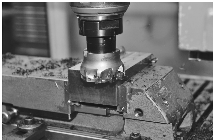
Figura 6.3: Usinagem de peça metálica. Um dos processos de fabricação mais antigos e mais comuns é o de usinagem, que é feito mediante a remoção de materiais por meio de lâminas, facas, pastilhas, etc. O formato final das peças usinadas é dado justamente pela remoção de material, até que reste somente a forma que se deseja (como se fosse uma escultura). Há diversas formas de usinagem: o material pode girar contra uma ferramenta fixa (como no torneamento); a ferramenta pode girar contra o material fixo (como o fresamento), etc.
