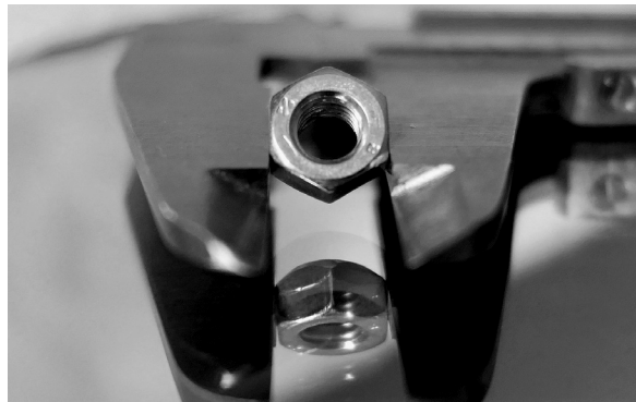
Figura 7.4: Medindo peças. Processos produtivos repetitivos, com alto volume de produção e, em especial, que produzam peças e componentes com medidas críticas para o bom funcionamento do produto final, são processos candidatos a serem monitorados por meio do gráfico de controle \bar{X} - s .
