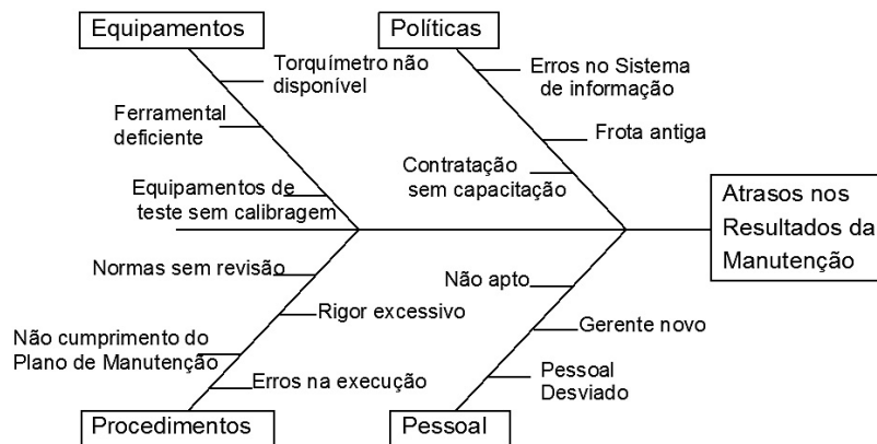
Figura 5.5: Exemplo de diagrama de causa e efeito. Como você pode observar, há quatro ramos e três deles são comuns aos 6 Ms, porém com nomes distintos: equipamentos (ao invés de máquinas); procedimentos (ao invés de método) e pessoal (ao invés de mão de obra). Já o quarto ramo aborda “políticas”.
