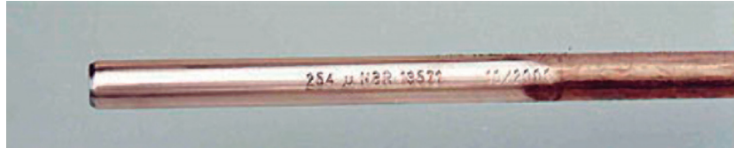
Haste tipo Copperweld 5/8" x 2,4 m; alta camada (254 micra) - NBR 13571
