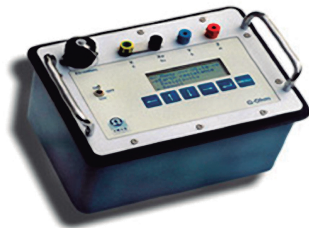
Terrômetro de três hastes
