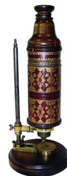
Figura 15.4: Microscópio manufaturado por Christopher Cock para que Robert Hooke realizasse as observações que formaram a base do seu livro Micrographia , no qual descreve seus inúmeros estudos em microscopia e óptica. Fonte: https://pt.wikipedia.org/wiki/Ficheiro:Hooke_Microscope-03000276-FIG-4.jpg .
