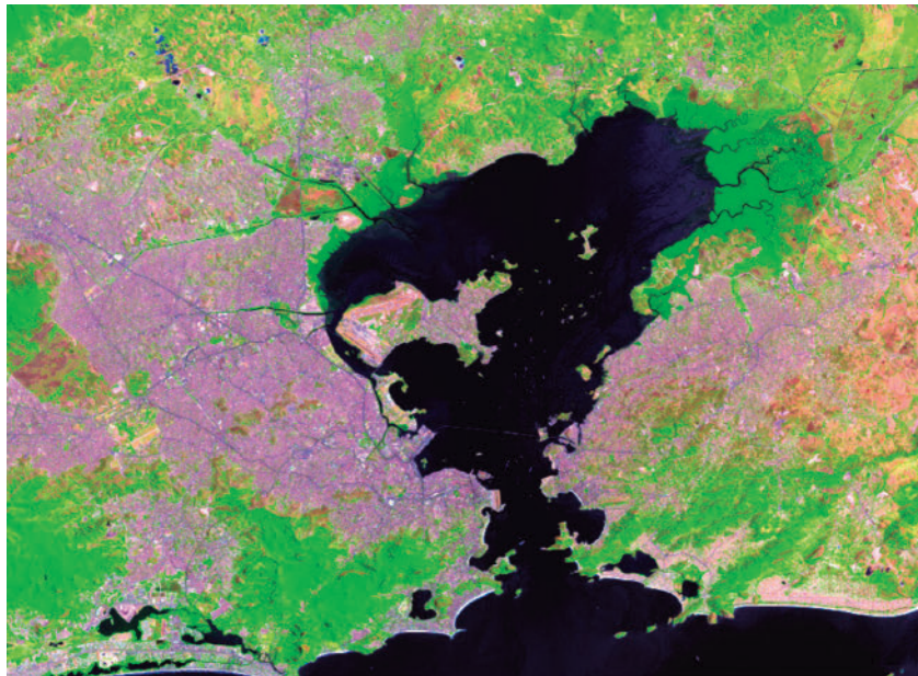
Figura 1.8: Região metropolitana do Rio de Janeiro. Os tons verdes caracterizam vegetação, os tons magenta caracterizam manchas urbanas ou solo exposto. Imagem coletada pelo satélite Landsat-8.
