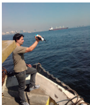
Figura 8.11: espectroradiômetro portátil é um exemplo de sensor não-imageador. Por meio desse equipamento é possível obter a curva de reflectância dos alvos que estão no ângulo de visada do sensor.
