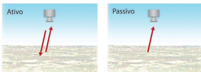
Figura 8.5: sensor ativo: emite o pulso e registra o eco do pulso após interagir com a superfície terrestre; sensor passivo: apenas registra o sinal de radiação emitido naturalmente pela superfície da Terra.
