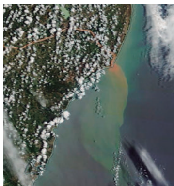
Figura 13.15: pluma de sedimento se dispersando a partir da foz do Rio Doce, ao longo da região costeira do estado do Espírito Santo, após o rompimento da barragem do Fundão em Mariana, Minas Gerais, Novembro de 2015. Imagem coletada pelo sensor MODIS, a bordo do satélite AQUA. As nuvens são destacadas em branco na imagem.
