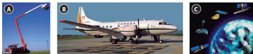
Figura 8.6: tipos de plataformas de sensoriamento remoto: (a) plataforma móvel sobre a superfície terrestre; (b) aeronave; (c) e satélite.
