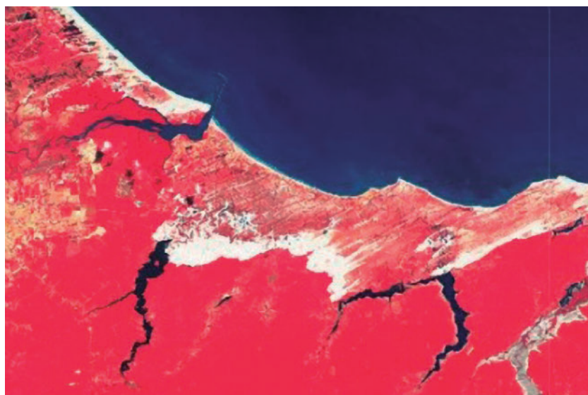
Figura 6.14: imagem coletada pelo sensor MSI a bordo do satélite Sentinel-2. O tons vermelho representam florestas, os tons de azul representam água e a cor branca representa areia.
