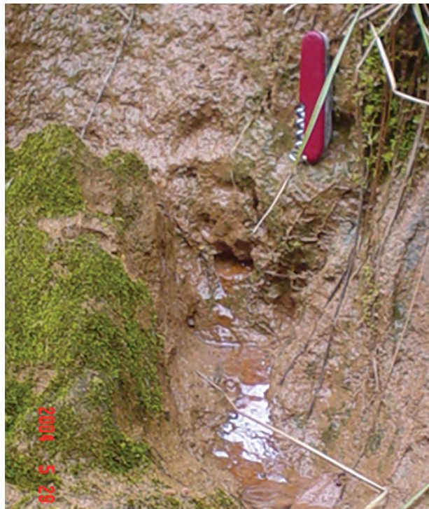
Figura 6.8: Exfiltração de fluxos subsuperficiais na parede de voçorocas. O vazamento constante durante o período chuvoso produz solapamento na parede da voçoroca que é o principal mecanismo de propagação das voçorocas nas encostas.
