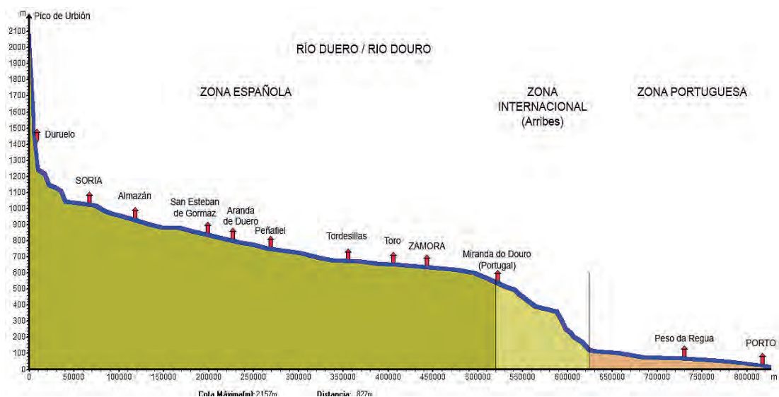
Figura 11.2: Perfil longitudinal do rio Douro, que drena áreas da Espanha e de Portugal.
