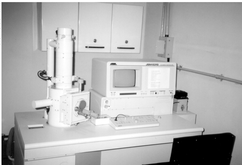
Figura 2.10: Foto de microscópio eletrônico de varredura Jeol 5310 em operação no Instituto de Biofísica da UFRJ.
