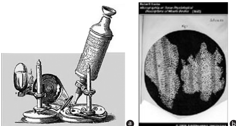
Figura 1.2: (a) Microscópio semelhante ao usado por Hooke. As partes componentes são análogas às dos microscópios usados hoje em dia. (b) Reprodução de um desenho feito por Hooke a partir da observação de lâminas de cortiça ao microscópio construído por ele. Cada um dos espaços foi por ele chamado de célula.
