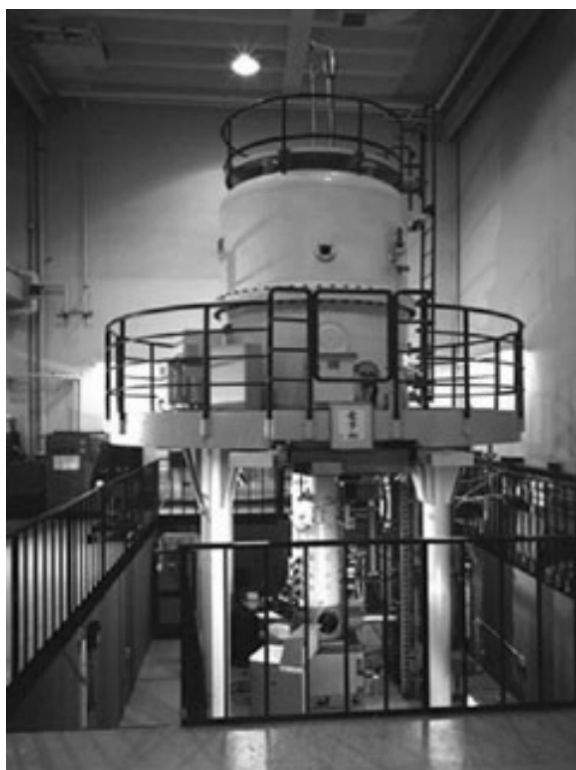
Figura 2.12: Microscópio eletrônico de alta voltagem (1.000 KV) instalado na Universidade do Colorado em Boulder. (Imagem retirada do site http://bio3d.colorado.edu/m.html ).
