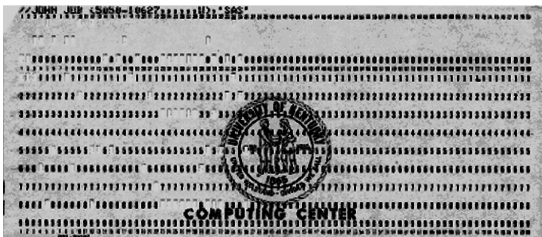
Figura 3.5: Cartão utilizado na máquina de Hollerith.
